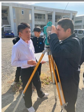
図1 トータルステーションで長さを測定する様子
