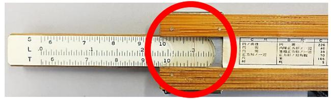
②計算尺を表に戻して、D尺1に対するC尺を読み取る。
